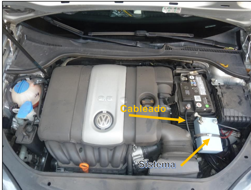
Figura. 4.4 Colocación del cerebro del sistema y cableado.
