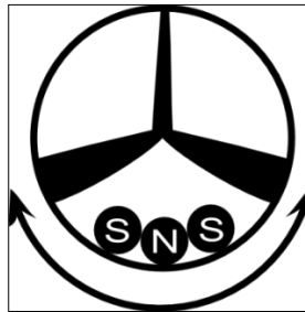
Figura. 3.7. Configuración de imanes en el volante.
